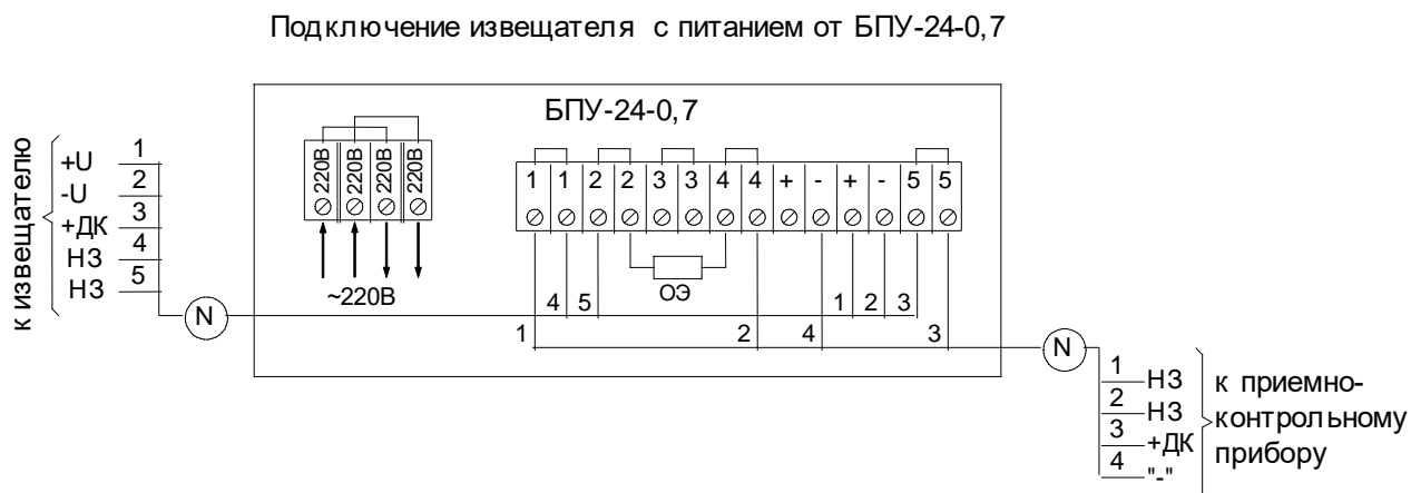
Рисунок 2.12 – Схема подключения извещателя к блоку питания «БПУ-24-0,7»
